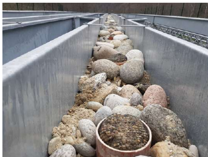
Figura 2 - I sacchetti di rete ripieni di sedimenti, posizionati all'interno dei cilindri nel substrato dei flumes
