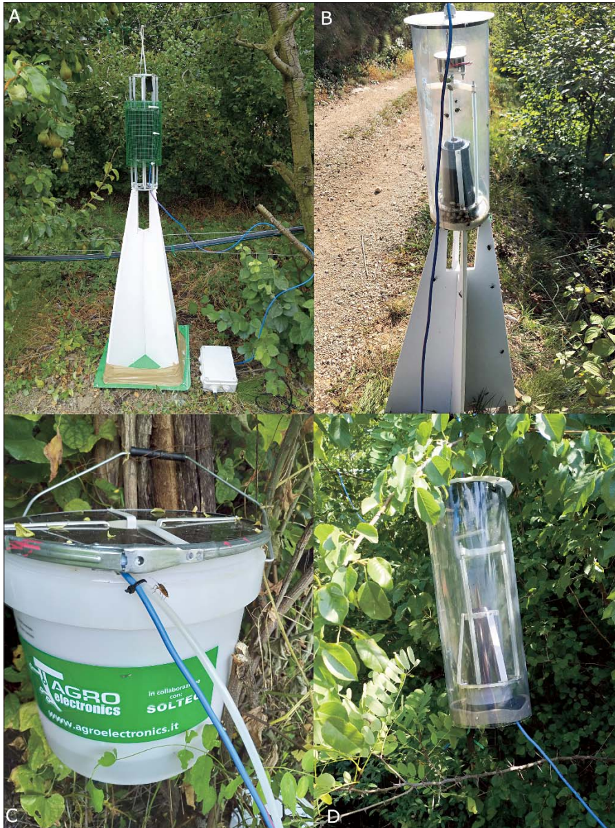
Fig. 2 – Prototipi di trappole multistimolo: (a) trappola a piramide con sistema di uccisione elettrico, (b) trappola a piramide con sistema di cattura a imbuto, (c) trappola a caduta, (d) trappola da appendere con sistema di cattura a imbuto.
