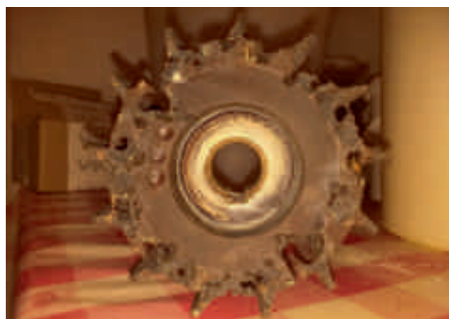
Girante di una pompa corrosa dal calcare.
