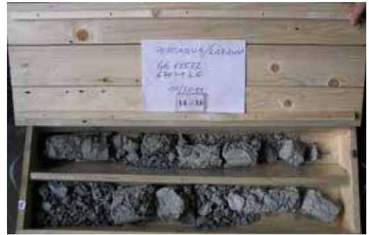
Fig. 7.6 – Carota tra 14 e 16 m di profondità: si tratta di till di alloggiamento della morena di fondo.
