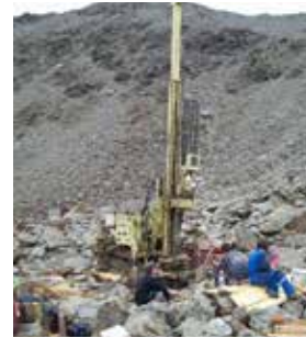
Fig. 7.2 – Nell'estate 2010 sono stati eseguiti due sondaggi a carotaggio continuo nel rock glacier Lazaun.
