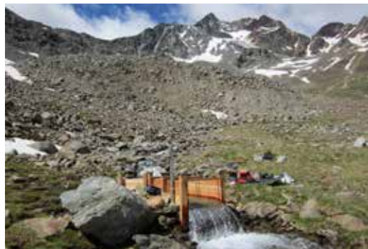
Fig. 4.1 – Idrometro per la misura della portata del torrente alimentato dal rock glacier di Lazaun.
