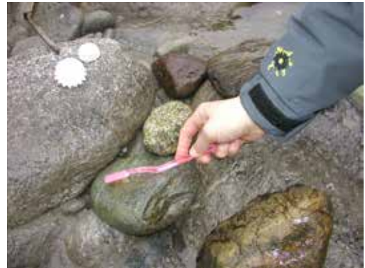
Fig. 6.6 – Campionamento delle diatomee con uno spazzolino da denti.
