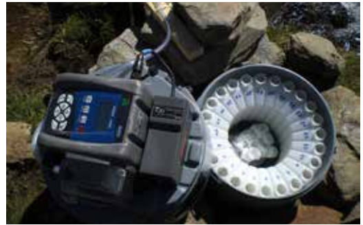
Fig. 5.3 – Raccoglitore automatico di campioni d'acqua collocato presso l'idrometro del rock glacier Hochebenkar.
