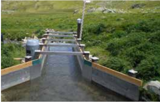
Fig. 5.2 – Idrometro per la misura della portata del torrente proveniente dal rock glacier Hochebenkar (Alpi Venoste).
