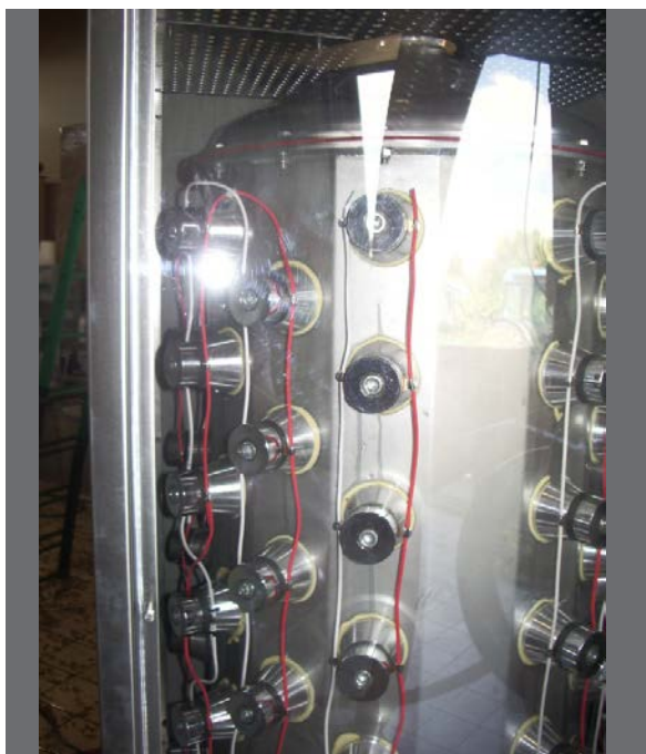
Figura 12.18 - Apparecchio per il trattamento di grandi volumi di feccia in cantina (27 KHz di frequenza).
