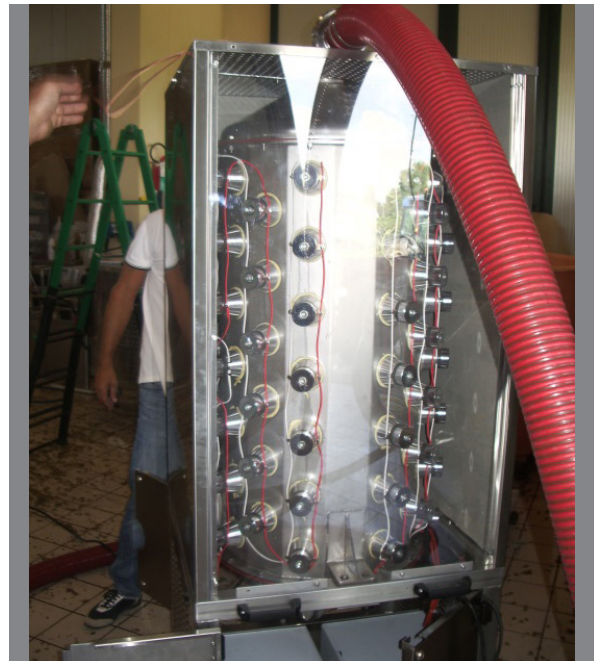
Figura 12.6 - Apparecchio ad ultrasuoni utilizzato nella applicazioni di cantina su grandi volumi (27 KHz di frequenza).
