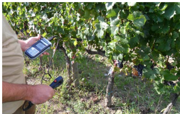
Figura 9.6 - Valutazione veloce in campo del potenziale fenolico delle bucce (ALCYONE PM-03, Caeleno srl, Verona, Italia).
