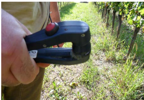
Figura 8.1 - Valutazione rapida in campo del potenziale fenolico (PMI - Phenolic Meter Index) delle bucce (ALCYONE PM-03, Caeleno srl, Verona, Italia).
