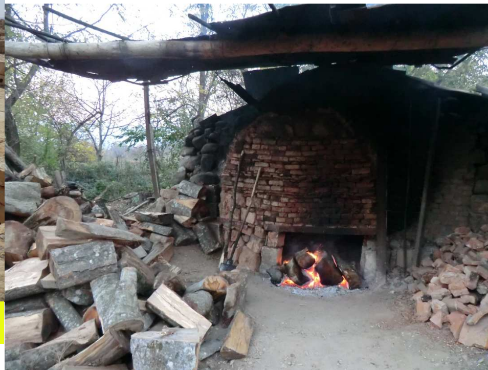
Forno per cottura anfore, Telavi (Georgia)
