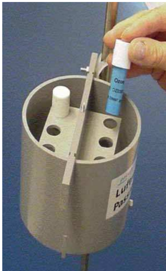
Campionatore passivo per l'ozono nell'apposito supporto
