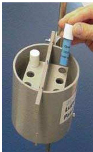
Campionatore passivo per l'ozono nell'apposito supporto
