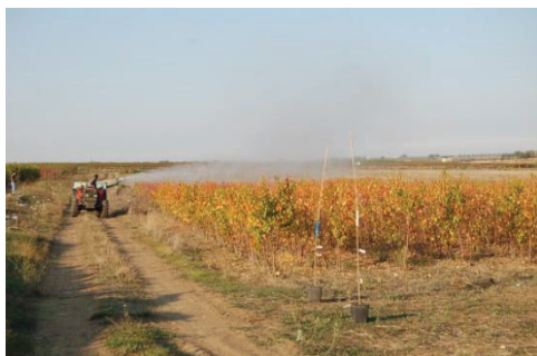
Figura 1. Trattamento del piantonaio con irroratrice dotata di diffusore a "cannone"
