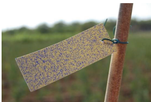
Figura 2. Bagnatura di una cartina idrosensibile evidenziata dalle aree di colore blu
