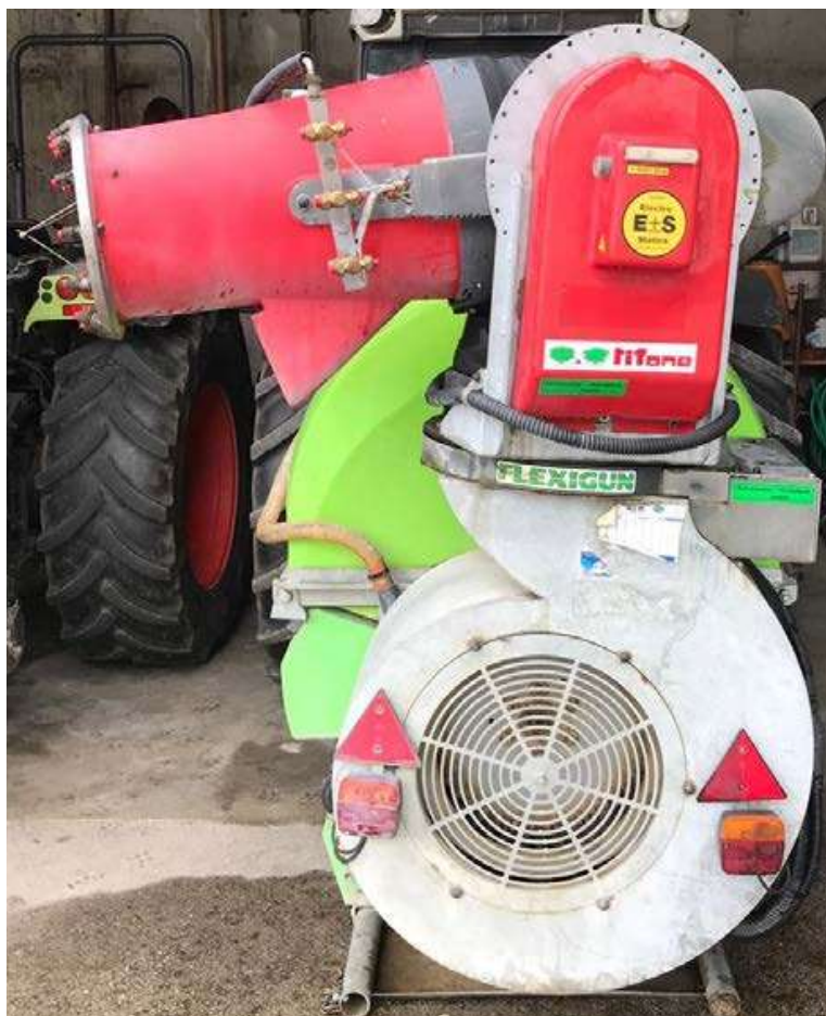
Figura 2. Irroratrice aziendale con convogliatore a cannone impiegata nei test
