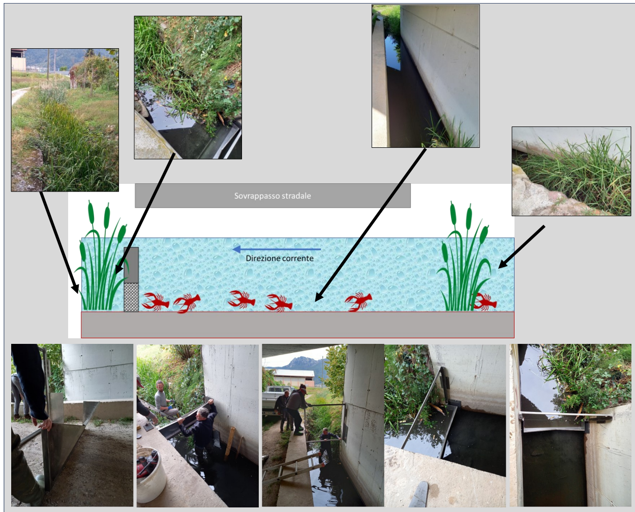
Figura 26. Schema della barriera fisica installata nel tratto terminale del Rio Valguarda il 16 ottobre 2023, ed immagini delle procedure di installazione, e della presenza di macrofite in alveo.
