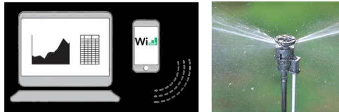
Fig.2: Sistema di acquisizione dati in iCloud, che permette di rilevare i parametri sopra descritti in continuo (ogni 15 minuti) e di attivare/disattivare da remoto l'impianto di irrigazione
