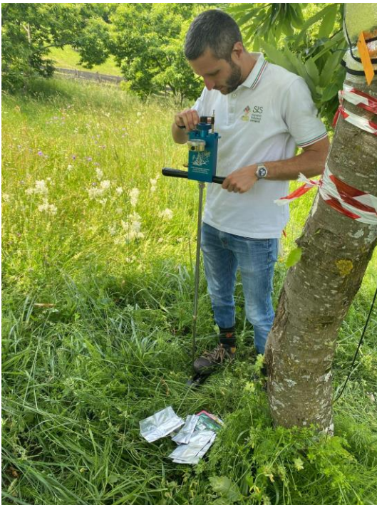
Fig.3 : Validazione dei sensori Florapulse tramite camera a pressione Pump-Up (PMS Instruments).
