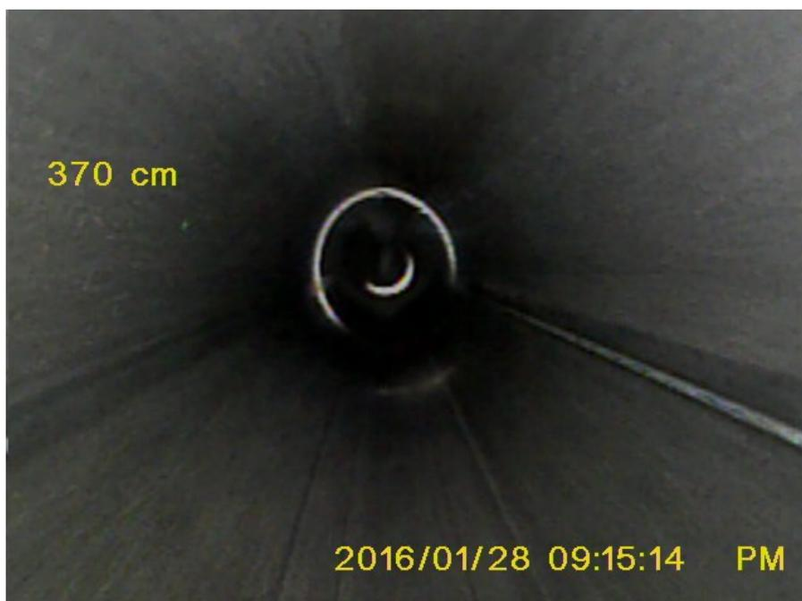
**Lattodotto: valutazione tubazione mediante sonda endoscopica. Superfici correttamente pulite**
