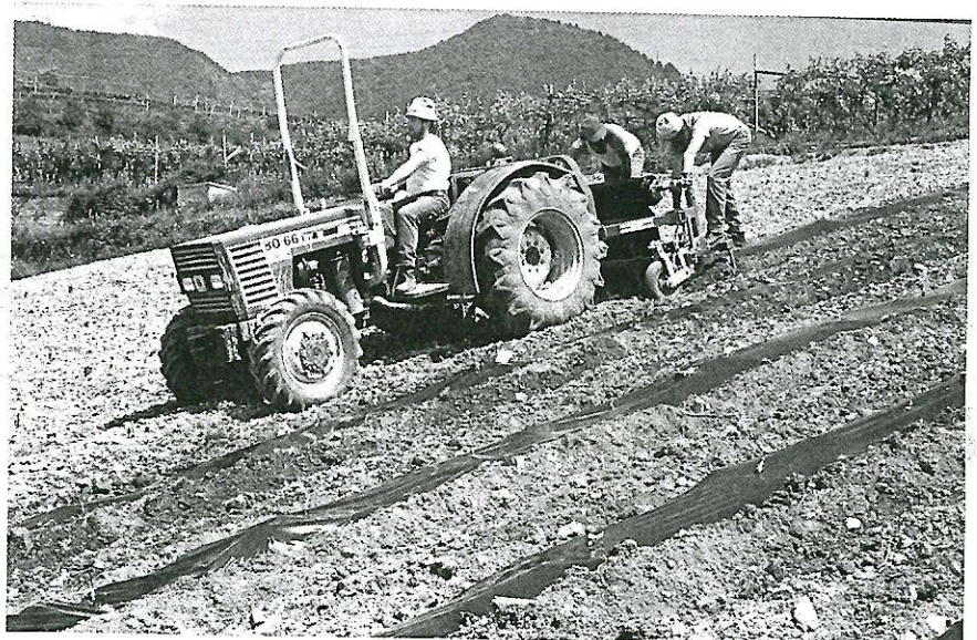
3) La macchina stenditelo è capace di fornire buone prestazioni anche nei terreni in pendenza.
