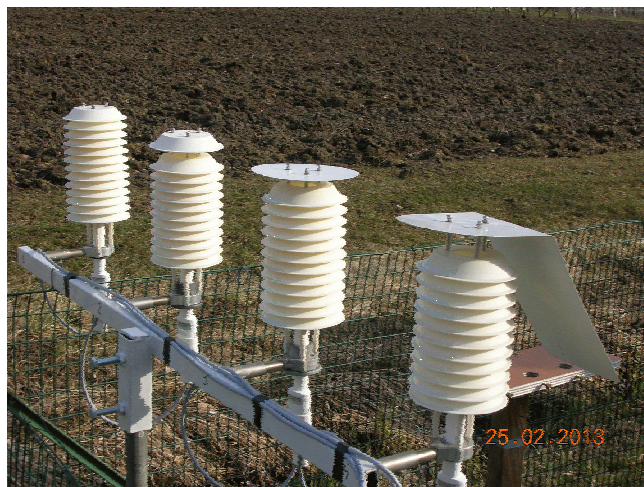
Fig.1 – Aspetto e disposizione degli schermi passivi.
